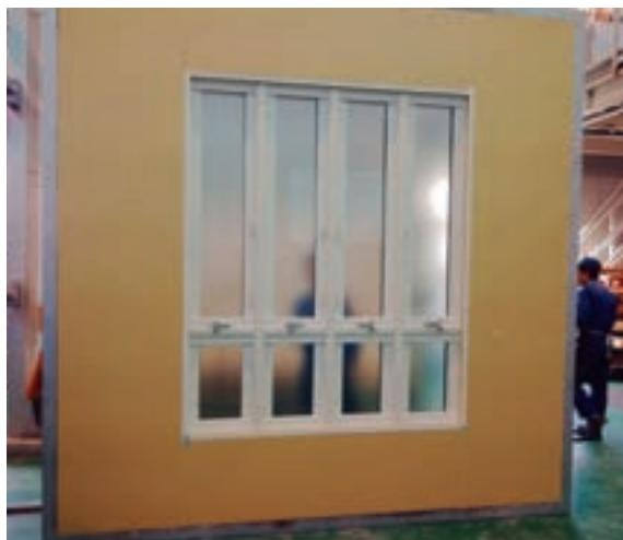
【防火試験体:すべり出し段装窓(W1664×H2017)】
