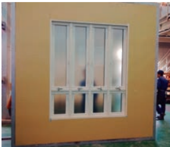
【防火試験体:すべり出し段装窓(W1664×H2017)】
