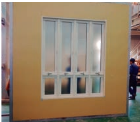
【防火試験体:すべり出し段装窓(W1664×H2017)】
